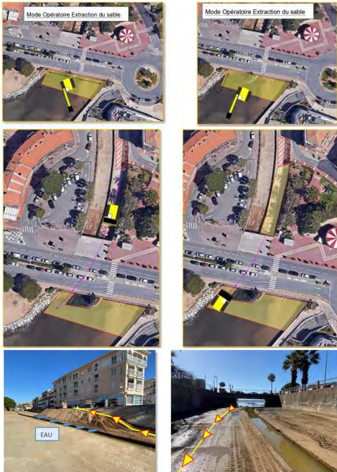
Figure 23 : Schémas de principe du mode opératoire 2 (source : CMME, 2022)
