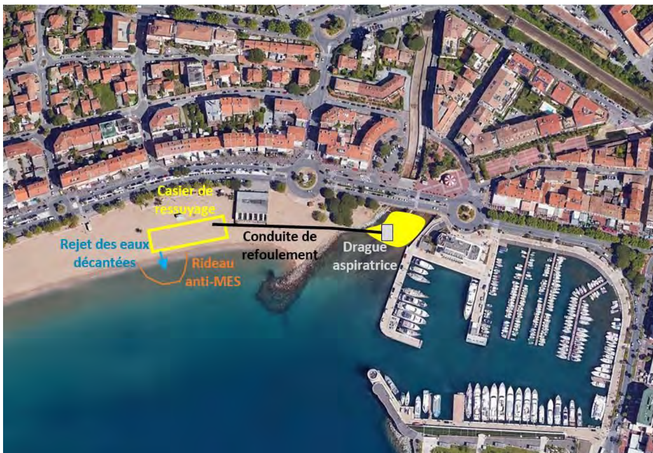
Figure 26 : Schéma de principe du ressuyage des sables dragués
