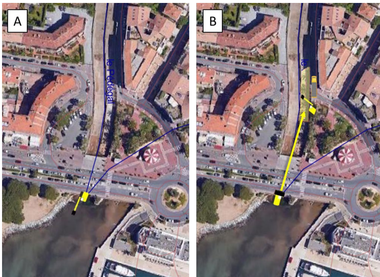
Figure 3 : Mode opératoire (A : extraction en partie aval ; B : mise en tas et reprise avant transport)
