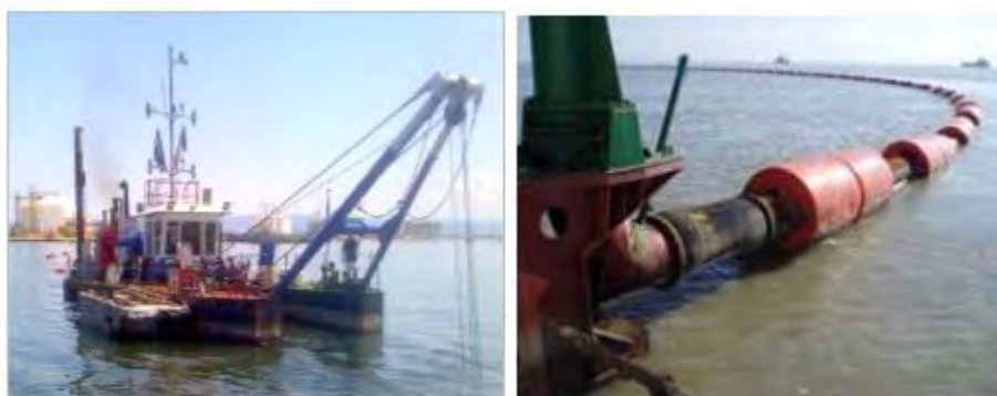
Figure 25- Illustration d'une drague aspiratrice stationnaire et conduite de refoulement
