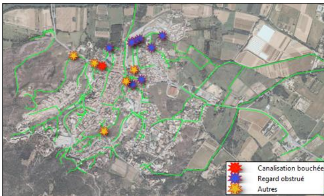
Figure 4-11 : Commune de Roquebrune-sur-Argens-Les défauts constatés sur le secteur le village (Source : [Artelia, 2016] – Traitement Hydratec)
