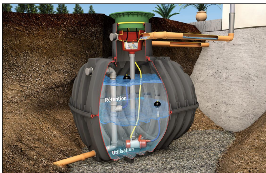
Figure 8-3 : exemple d'ouvrage de rétention / récupération des eaux pluviales
