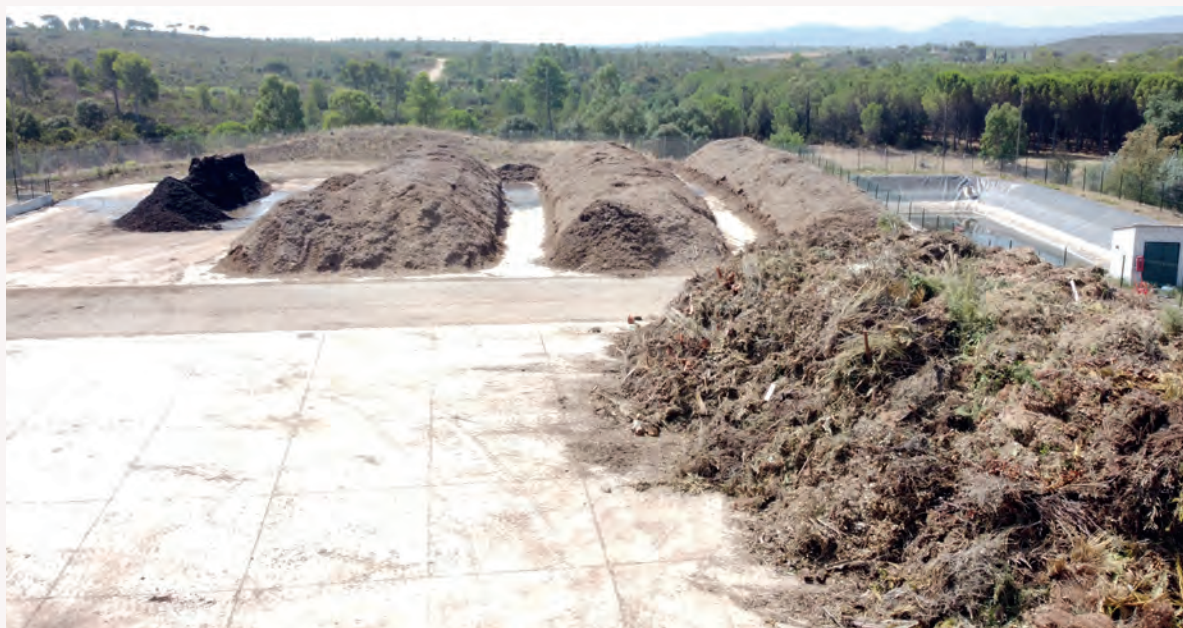
Andins (tas de compost) en cours de maturation
