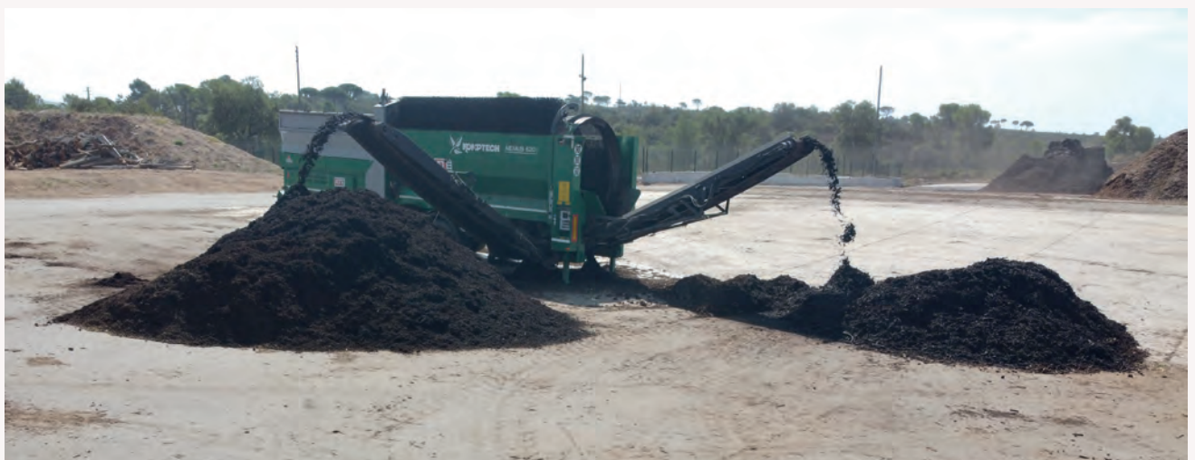
Criblage du compost
