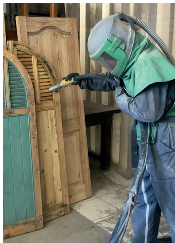
Fabio, employé d'Atout Gommage, procède au décapage d'un volet.
