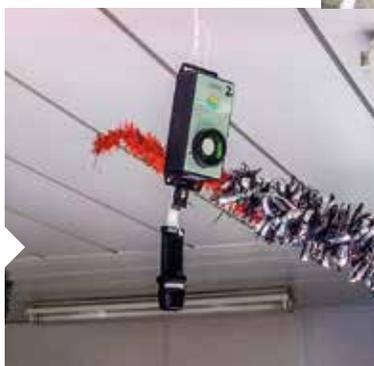
Mesure de polluants intérieurs à l'aide d'un capteur suspendu au plafond
