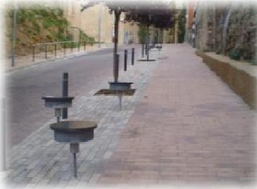
Exemple d'aménagement d'une rue à forte déclivité avec d'un côté des « sièges de repos » et de l'autre une main courante
